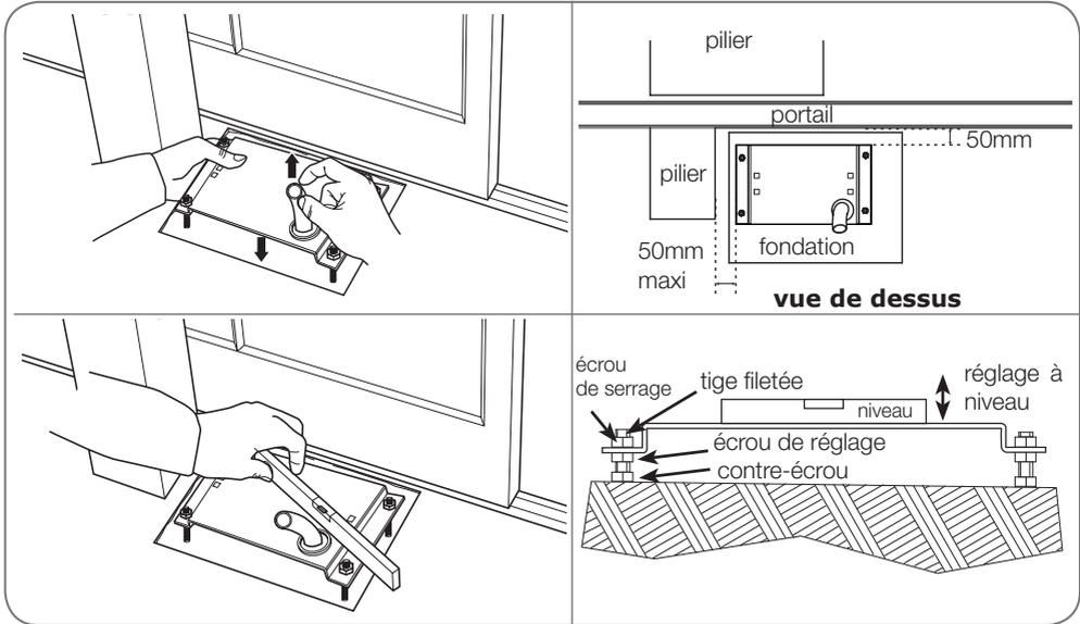
Lorsque le socle est bien horizontal, serrez les contre-écrous pour bloquer l'écrou de serrage puis serrez les écrous de serrage pour maintenir le socle en position.
