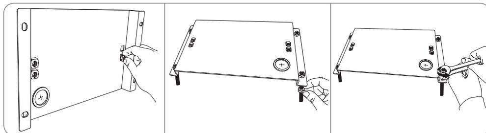
Le socle de fixation peut être ancré à la dalle de fondation par des tiges filetées préalablement scellées dans la fondation.
