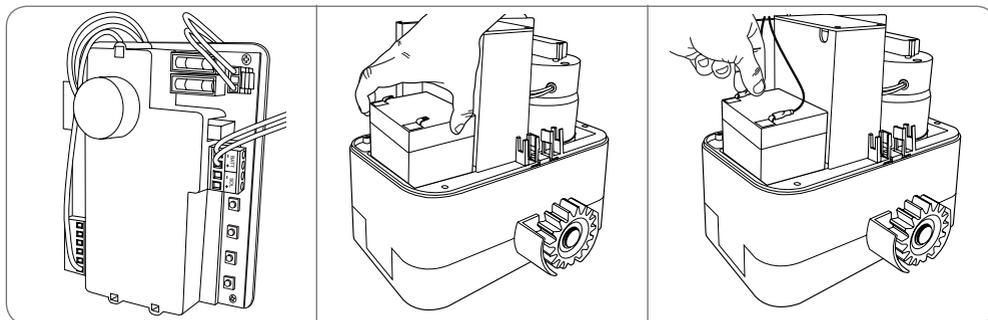
Après ce test, rebranchez l'alimentation (disjoncteur de protection en position ON). La batterie prendra le relais en cas de coupure de courant.
