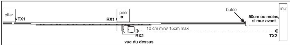
En branchant les photocellules de cette manière, le système réagit à une coupure de l'un ou l'autre des faisceaux infrarouge pendant la fermeture, et du faisceau bord secondaire en ouverture.
