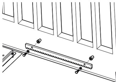
**Méthode 2 :** Utiliser des vis M8 de longueur appropriée pour traverser le portail. Les entretoises et les éléments de crémaillères seront fixés ensemble avec ces vis et des écrous M8 (non fournis).
